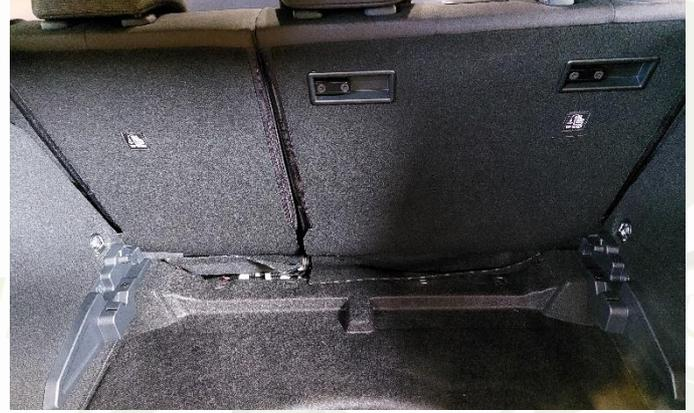
c) Débrancher les connectiques et les 2 câbles d'inclinaison de siège
