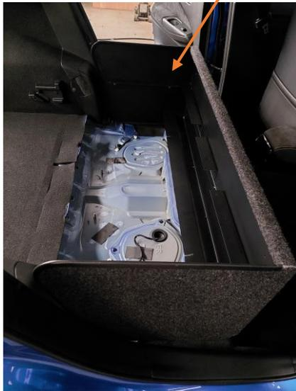
Fixation de l'arrêt de charges à l'aide de 2 vis hexagonales M8x20
