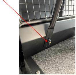
5) Fixer les 2 arceaux sur le point d'ancrage des sièges arrières
